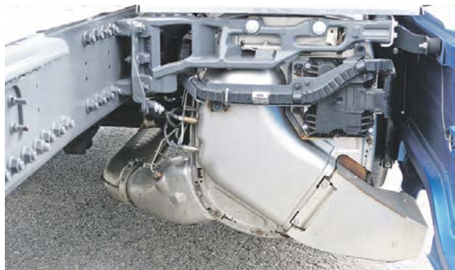
Spart Gewicht und Bauraum: nur teilweise verkleidete SCR-/Filter-Einheit.
