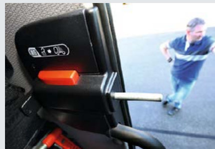
Unbedingt zu empfehlen: Night-Lock-Türverriegelung. Im Eco-Modus sind keine manuellen Eingriffe möglich
