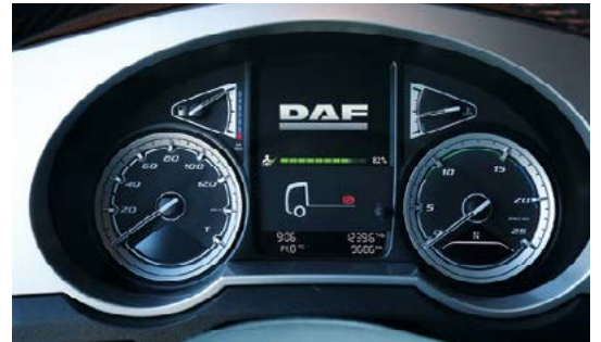
Die Rundinstrumente erhielten beim Facelift neue Zifferblätter und der Bordcomputer neue Funktionen
