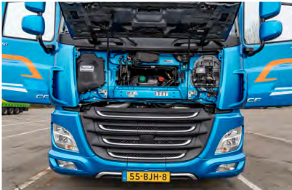
DIE SERVICEPUNKTE präsentieren sich wie gehabt, einen Ölstab gibt es nur noch direkt am Motor.
