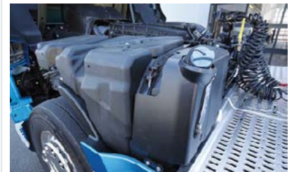
Den AdBlue-Tank montiert DAF erhöht
