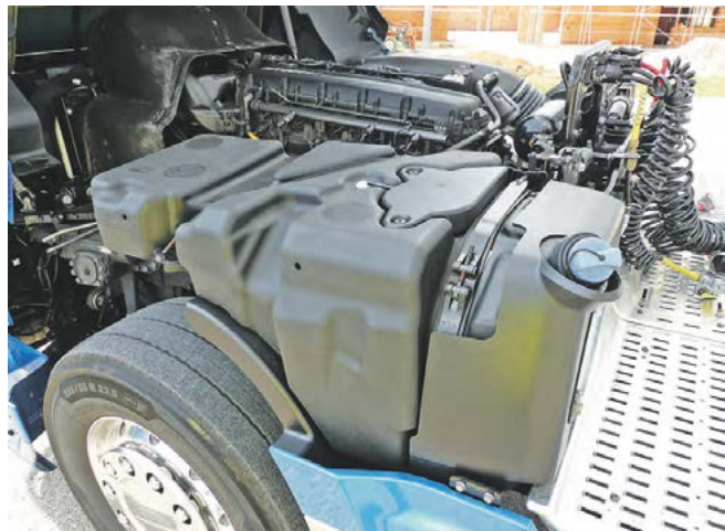
Damit kommt man weit: Der 90 Liter große AdBlue-Vorrat unter der Kabine sorgt für mehr Anbauräum für Dieseltanks.
