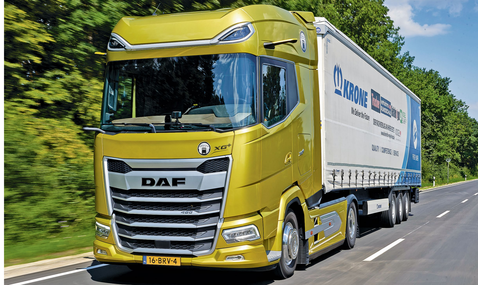
Die um 16 Zentimeter verlängerte und abgerundete Front verbessert die Aerodynamik deutlich
