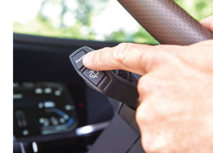
Nicht optimal: Den kleinen Knopf für die Hupe muss man im Ernstfall zu lange ertasten
