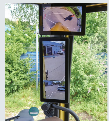
Unauffällig gutes Spiegelersatzsystem (Option) mit digitalem Front- und Rampenspiegel
