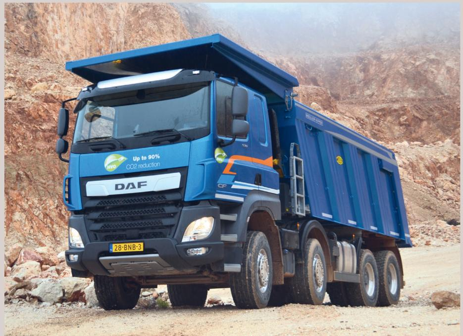
Für besonders harte Offroad-Anwendungen: der CF 480 FAD „Construction“ in 8x4-Achskonfiguration
