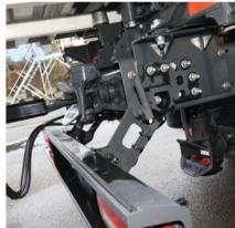
Standard- oder Tiefkuppel-Anhänger? Das Testfahrzeug kann beides
