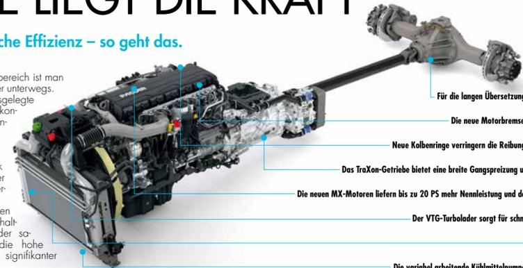
Für die langen Übersetzungen fertigt DAF spezielle reibungsarme Zahnräder.
