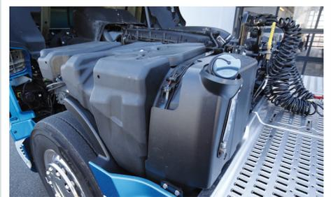
Den AdBlue-Tank montiert DAF erhöht
