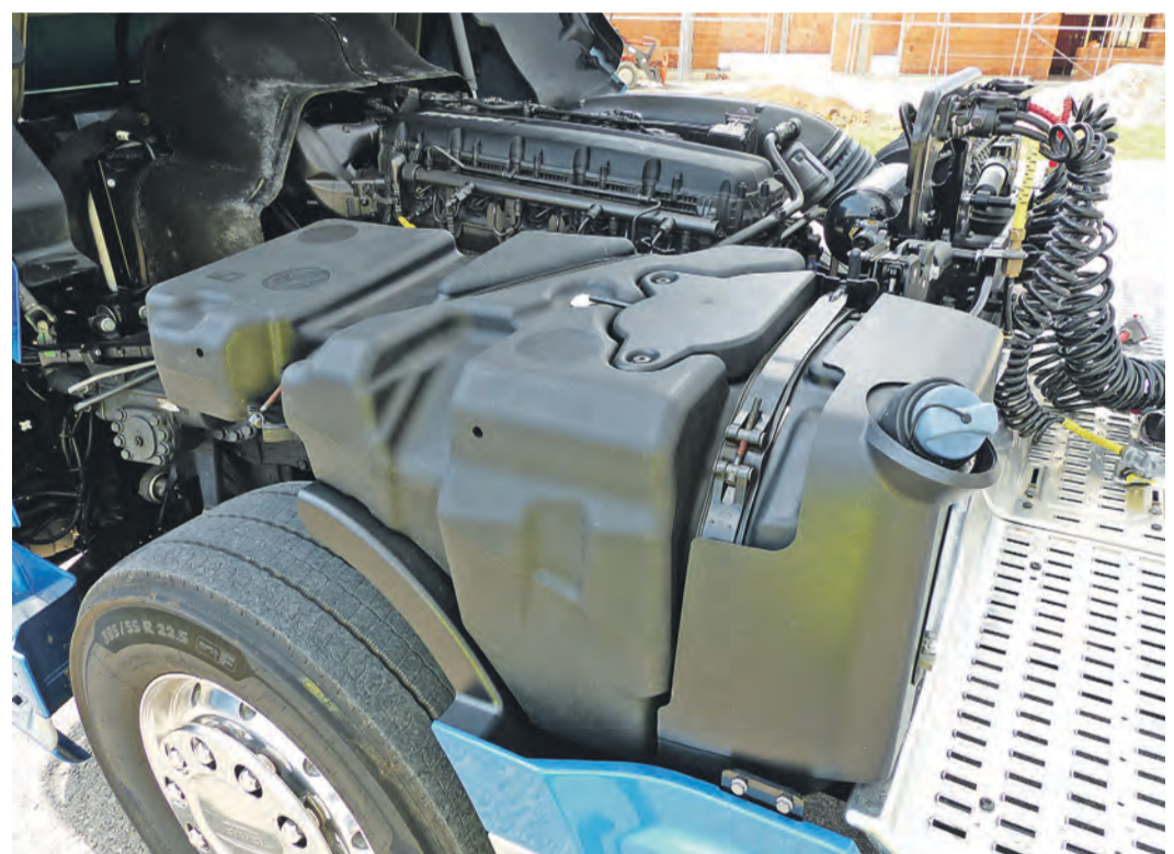
Damit kommt man weit: Der 90 Liter große AdBlue-Vorrat unter der Kabine sorgt für mehr Anbaurraum für Dieseltanks.
