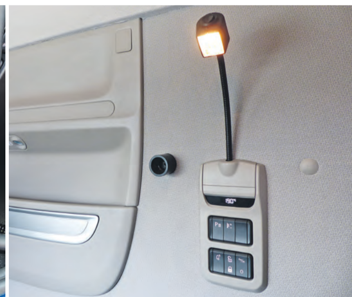
Die wichtigsten Funktionen für die Nacht lassen sich von diesem einfachen Panel aus steuern. Power-Outlet über der Zeitschriften-Ablage.
