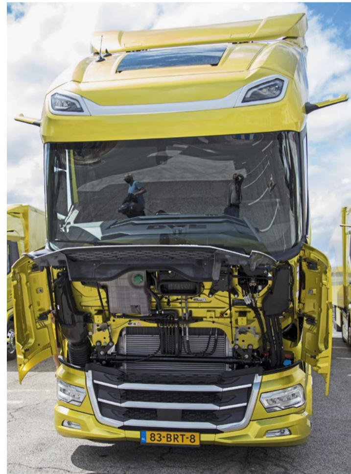
Optimiert: Elliptische Rundungen außen und ein verbesserter Luftfluss unterm Blech verbessern den Verbrauch erheblich.
