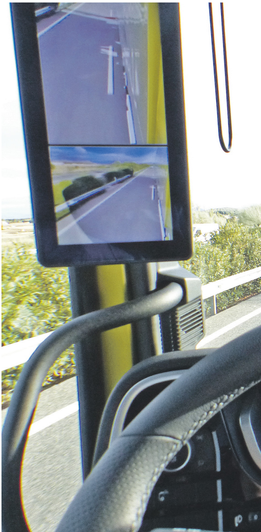
Der Linke Monitor sitzt wegen des raumgreifenden Einstiegsgriffs etwas hoch und erfordert das Heben des Blicks.
