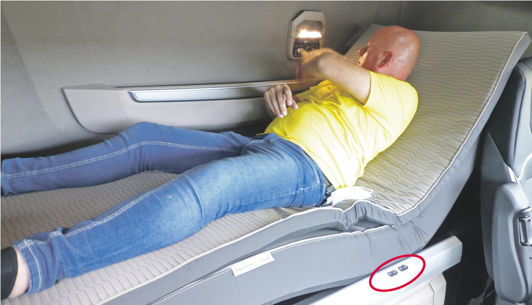
Das Nacht-Panel ist bei aufgestellter Lehne nur schwer zu bedienen, mittig in der Rückwand wäre besser. Die Tasten für die elektrische Verstellung (rot markiert) liegen optimal. Die Stellmotoren arbeiten allerdings ziemlich langsam.
