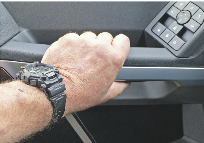
Praktisch: Türentriegelung per Daumendruck. Die Tür bleibt immer unter Kontrolle beim Öffnen. Rechts oben das Bedienfeld für die Kamera-Spiegel.
