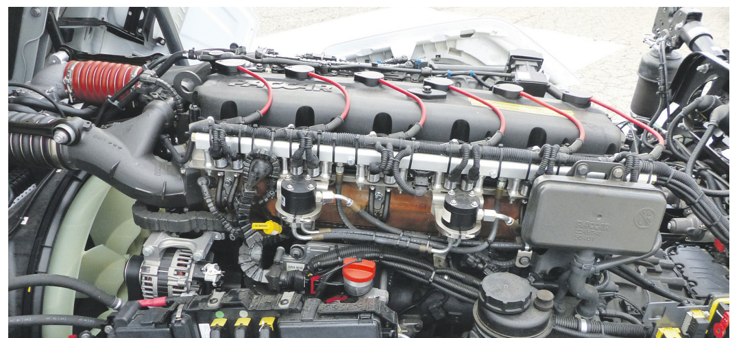
Mutig: DAF wagt sich an die fremdgezündete H2-Direkt-Verbrennerversion des 13 Liter großen MX 13. Nur eine von zahlreichen Herausforderungen: in sehr kurzer Zeit genug H2 in den Brennraum zu bekommen.
