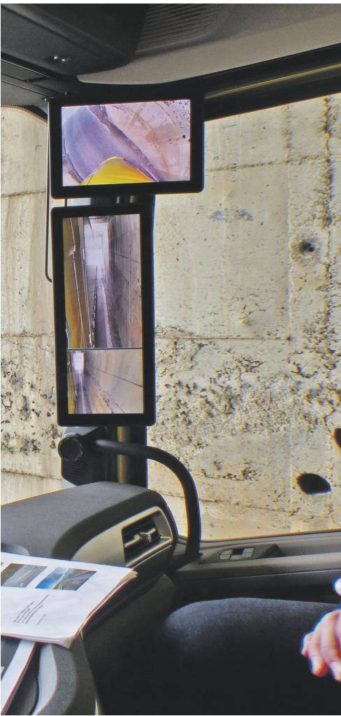
Irritierend: Der obere, quer liegende Monitor zeigt unnötigerweise auch bei höheren Geschwindigkeiten die vordere rechte Ecke. Besser, aber zulassungstechnisch wohl nicht erlaubt, wäre das Abschalten ab 60 km/h.
