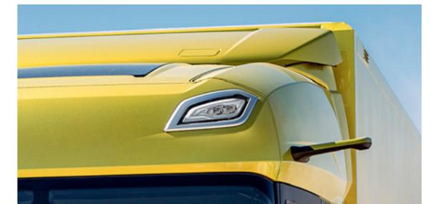
Die richtige Einstellung des Windabweisers kann bis zu 10% Kraftstoff und CO<sub>2</sub>-Emissionen einsparen. Das DAF-Kameraspiegelsystem bietet die perfekte indirekte Sicht für optimale Sicherheit, und dank seines aerodynamischen Designs lassen sich dadurch 1,5% Kraftstoff und CO<sub>2</sub>-Emissionen einsparen.
