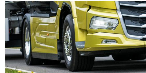
Die Wahl von Reifen mit dem geringsten Rollwiderstand (Typ A oder B) trägt zur höchsten Kraftstoffeffizienz bei. Der Wechsel zu einer Kategorie mit noch geringerem Widerstand führt je nach Anwendung zu einer weiteren Kraftstoff- und CO<sub>2</sub>-Einsparung von etwa 2–2,5%.
