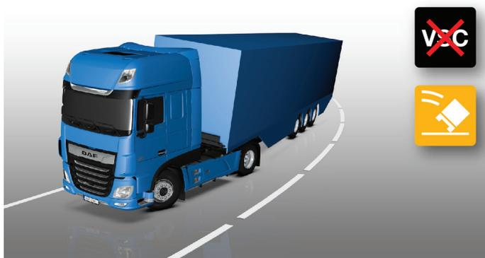
Beim Untersteuern schiebt die Fahrzeugfront zum Kurvenäußeren, und wenn dieser Vorgang nicht korrigiert wird, kommt das Fahrzeug von der Fahrbahn ab. VSC betätigt die Bremsen an den kurveninneren Rädern, um die Zugmaschine zurück in die richtige Spur zu bringen.
