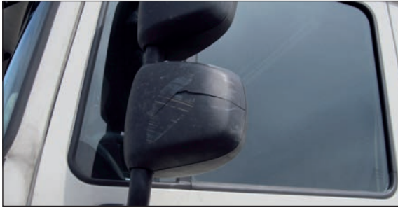
Spiegelgehäuse, verkratzt mit Glasbruch
