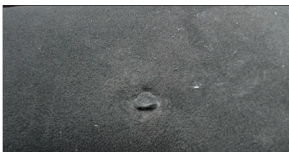
Loch im Innenraum Motorabdeckung
