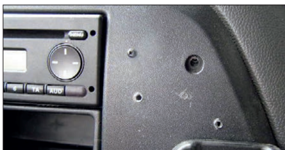
Bohrlöcher im Armaturenbrett/Ablagen
