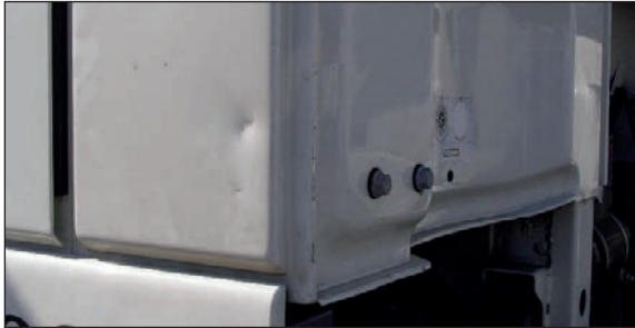
Fahrerkabine hinten, Anfahrtschaden/Beule
