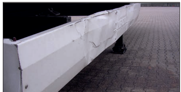
Anfahrsschaden Anbauteile/ Seitenanfahrerschutz
