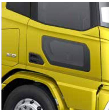
TÜR MIT BORDSTEINFENSTER
